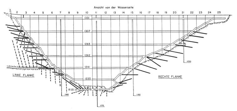
Figure 7. Forages de drainage sous le pied aval du barrage.
