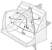
Figure 2. Schéma du volume rocheux «quasi tétraédrique» et forces qui le sollicitent (d'après P. Londe).
