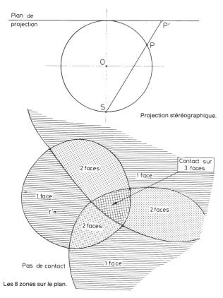
Figure 3. Représentation, sur une sphère et - par projection stéréographique sur un plan, des 8 zones correspondant aux cas de stabilité (1 zone) et d'instabilité (7 zones) du bloc «quasi tétraédrique» sollicité par une force résul-
