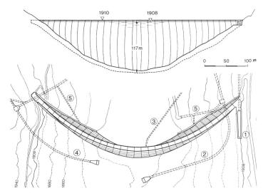
Bild 1. Die Staumauer Sta. Maria. 1 Hochwasserüberfall, 2 Grundablass, 3 Drainagestollen, 4 Druckstollen, 5 Zugangsstollen.
