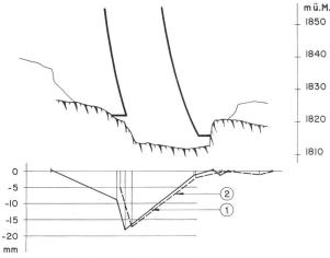
Bild 2. Fundamentsetzungen der Staumauer Sta. Maria
