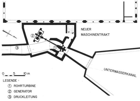
Bild 2. Grundriss der neuen Zentrale Kallnach im Massstab 1:500.
