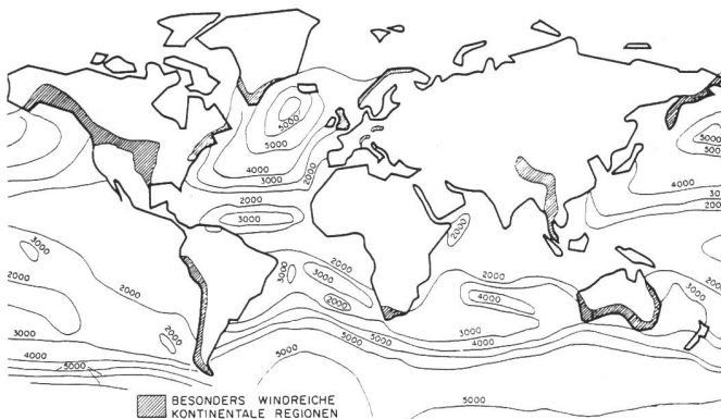
Bild 15. Jährlich verfügbare Windenergie, in kWh für eine Windturbine mit 55 m Flügelspannweite.
