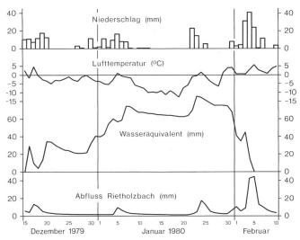
Bild 2. Tagesmittel der Lufttemperatur (°C), des Wasseräquivalents der Schneedecke (mm), des Abflusses (mm) und Tagessummen des Niederschlages (mm). Messstation Büel (750 m ü. M.), Einzugsgebiet Rietholzbach.
