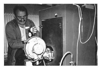
Messtechnische Überprüfung der Brennstoffzufuhr zu einem Ölbrenner.
