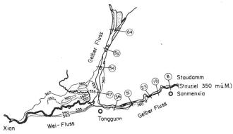
Bild 5. Stauraum des Staudammes bei Sanmenxia. Stauziel 1960, 353 m ü. M.
