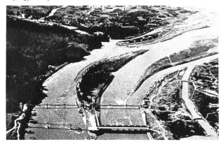
hals «Baopingkou». «Baopingkou» ist durch einen künstlichen Durchstich im anstehenden Felsen entstanden und bildet die eigentliche Fassung des Werkes. Seine Breite beträgt rund 20 m. Mit zunehmender Wassermenge steigt der Wasserspiegel vor dieser Einengung stark an und erzeugt einen Rückstau im «Inneren Flusslauf». Die Entlastung «Feishayan» tritt in Funktion und leitet das überschüssige Wasser in den alten Flusslauf zurück (Bild 2).
