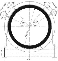
Bild 3. Querschnitt Einzugschlitten im Massstab 1:20.
