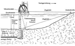
Bild 8. Schematische Darstellung des Hochdruck-Einspülverfahrens.
