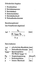
Bild 1. Bemessungen von Dükerleitungen aus PE hart (Druckrohrleitungen).
