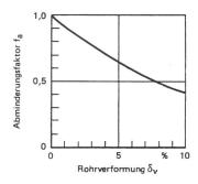
Bild 4. Abminderungsfaktor für die Verwendung in Gl. (2) abhängig von der Rohrverformung.
