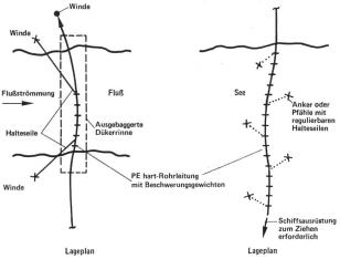
Bild 7. Schematische Darstellung des Einschwimmverfahrens
