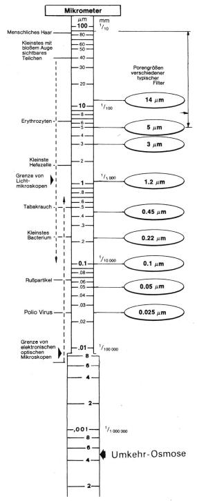
Bild 1. Die Porengrössen bei verschiedenen Filtern im Vergleich mit andern kleinen Grössen. Die vom Installateur normalerweise verwendeten Filtergrössen liegen zwischen 5 und 100 µm. Die Porengrössen der Membrane bei der Umkehr-Osmose liegen bei 0,05 µm.
