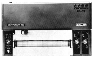
Papierantrieb mit progressivem Vor- und Rücklauf zur genauen und schnellen Papierpositionierung.
