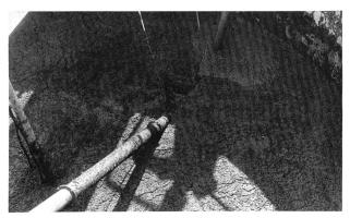
Bild 2. Versuche mit Flüssigrotte zur selbsttätigen Entwässerung durch Flotation. Flotation ist die Voraussetzung des Überganges von der Flüssigrotte in die Feuchtrotte. Die Risse im Flotat des Hygienisierungsreaktors (helle Fläche) zeigen den Trocknungsvorgang in der Stufe der Flüssigrotte an. Diese einfache Art der selbsttätigen Entwässerung kann bei der Flüssigrotte durch richtige Steuerung erreicht werden.
