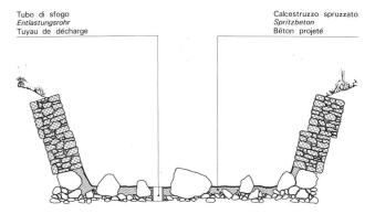
Bild 11: Mit Spritzbeton abgedichtetes Flussbett.
