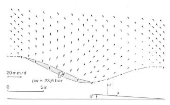
Bild 6. Resultate einer Studie mit finiten Elementen über die Bewegungsverhältnisse in der Basisschicht eines idealisierten Gletschers bei Wasserdruckänderung an der Gletschersohle (oben: Öffnen einer Kaverne bei Druckanstieg; unten: Schliessen bei Druckabfall). Nach [7].
