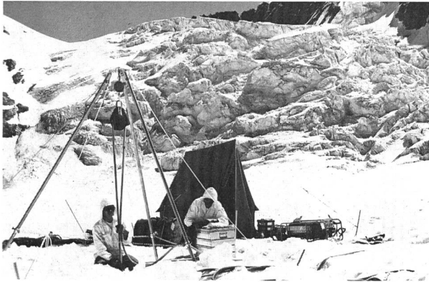
Bild 2. Thermische Tiefbohrung auf dem Brenay-Gletscher. Rechts vom Zelt Durchlauferhitzer und Pumpen. (Aufnahme H. Röthlisberger, 23. 7. 1977)
