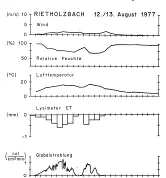
15 Bild 3. Tagesgang verschiedener hydrometeorologischer Elemente an einem Sommertag an der Station Büel (Rietholzbach). Die Globalstrahlung hängt eng mit der mit dem Lysimeter direkt gemessenen Verdunstung zusammen.
