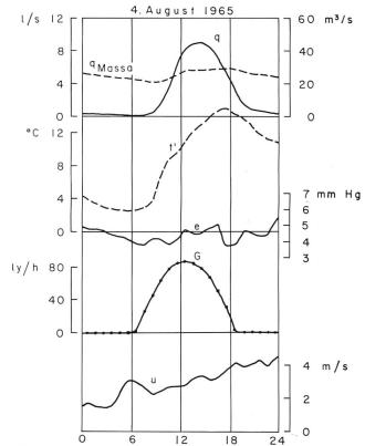
Bild 8. Beispiel eines Tagesganges des Abflusses vom Experimentierfeld auf dem Aletschgletscher (q) und der Massa. Dazugehörige meteorologische Parameter: Lufttemperatur, registriert neben dem Gletscher (t'), Wasserdampfdruck (e), Globalstrahlung (G) und Windgeschwindigkeit (u), auf dem Gletscher gemessen.
