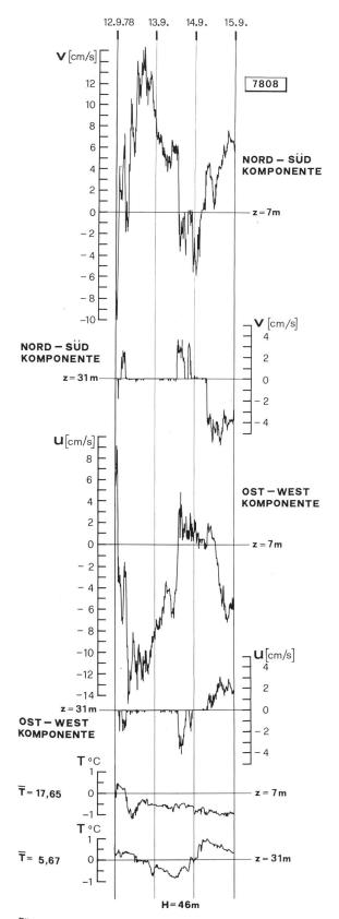
Bild 14. Ausschnitt aus den Strömungs- und Temperaturregistrierungen der Messposition 8 im Zürichsee.
