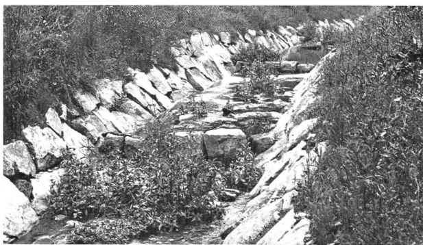
Bild 8. Mosul-Modell. Ausschnitt des Hochwasserentlastungsgerinnes. Abfluss einer Wassermenge von 10 000 m 3 /s (Natur) über den Skisprung am unteren Ende der Schussrinne.
