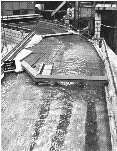
Bild 3, links. Modell eines Reussausschnittes im Massstab 1:40. Überprüfung des umgebauten Reusswehres (Nadelwehr) bei Luzern, das der Regulierung des Wasserstandes im Vierwaldstättersee dient.
