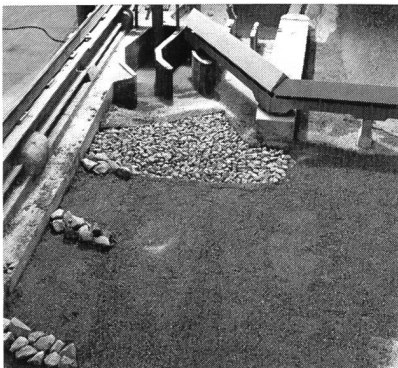
Bild 5. Reussmodell Luzern. Detailaufnahme des getesteten Blockwurfes zur Ufer- und Sohlensicherung.
