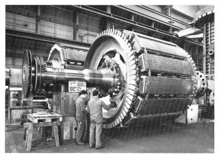
Bild 1. Polrad des im Wasserkraftwerk Bitsch im Oberwallis montierten dritten Generators. Für den Transport wurden die Pole abgenommen. Das Gewicht betrug dennoch  $105\,\mathrm{t}$ .
