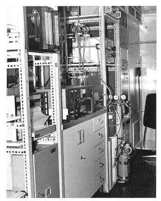
Bild 3. Blick in den Messwagen mit Messgeräten und Computer zur Erfassung und Auswertung der luftfremden Stoffe.
