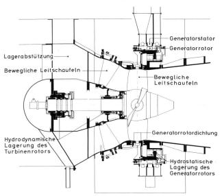
Bild 1. Schnitt durch die Niederdruck-Wasserturbine Straflo, wie sie in die Anlage Höngg eingebaut wird.
