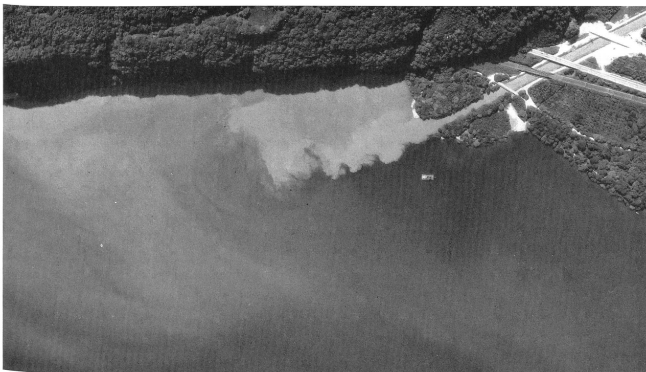
Bild 3. Luftaufnahme der Linthmündung bei starker Trübung infolge Hochwassers. Die rechtsseitige Ablenkung des Mündungsstrahles ist deutlich zu erkennen. (Aufnahme der Eidg. Landestopographie, 2.6.1978).
