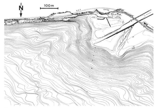
Bild 2. Ausschnitt aus der Seegrundkarte von 1911 (*Collet* und *Stumpf*, 1916): Vor der nach Osten mündenden Linth sind am Deltahang subaquatische Rinnen zu erkennen, die West/Ost gerichtet sind. Der nach NNE gerichtete (abgeschnittene) Mündungsarm ist eine Folge des Hochwassers von 1910, als die Linth unmittelbar nach der Eisenbahnbrücke den linken Damm durchbrach.
