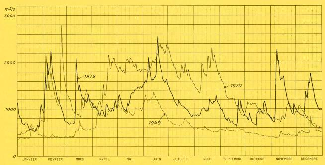
I Abflussmengen des Rheins bei Rheinfelden: Einzugsgebiet 34 550 km², Vergletscherung 1,6 %. Jahresabflussmenge 1935–1979 1023 m³/s; Jahr 1979 1122 m³/s.
