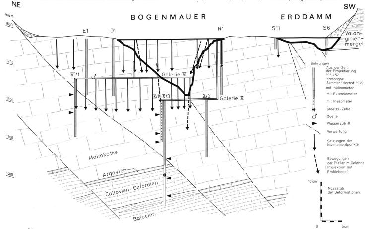
Bild 6. Längsprofil durch den Riegel von Zeuzier, Deformationen zwischen den Messungen G und K, das heisst von 1972 bis Herbst 1979, siehe Beitrag Egger.
