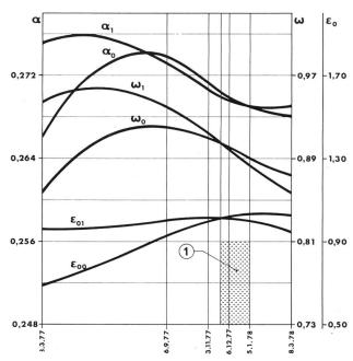
Figure 9. Détermination du début de la poussée anormale du barrage vers l'a-
