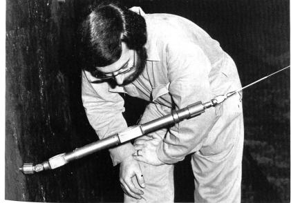
Deformationsmessung eines Tunnelprofils mit dem Distometer ISETH
