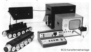
Der Bildschirmfotoapparat wird über die Steuer- und Überwachungskonsole ausgelöst. Die elektronische Bildzählung wird zusätzlich auf dem Monitor ersichtlich. Das Einführen des Films sowie dessen Transport erfolgen automatisch. Die ganze Kanalfernseh-Anlage wird in einem Nutzfahrzeug untergebracht. Der Spezialausbau des Fahrzeuges erfolgt durch die BCS Bauconsult System AG.
