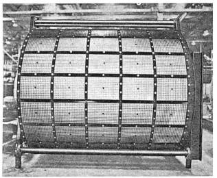
Mikrosiebtrommel, Durchmesser 3 m und 3 m lang
