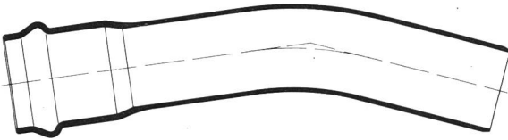
Muffenbogen aus Hart-PVC, NW 50 bis 150
