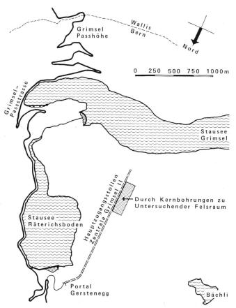
le Kernbohrungen ausgeführt werden mit einem Kerndurchmesser von zirka 5 cm. Der Standort Grimsel bietet sich für solche Versuche deshalb an, weil hier das Grundgebirge aufgeschlossen und durch bestehende Stollen bereits erschlossen ist. Experimente mit radioaktiven Stoffen sind nicht vorgesehen.
