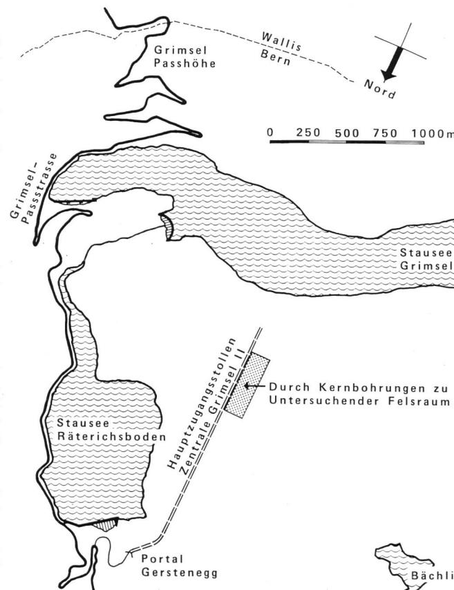
Die Kernbohrungen ausgeführt werden mit einem Kerndurchmesser von zirka 5 cm. Der Standort Grimsel bietet sich für solche Versuche deshalb an, weil hier das Grundgebirge aufgeschlossen und durch bestehende Stollen bereits erschlossen ist. Experimente mit radioaktiven Stoffen sind nicht vorgesehen.
