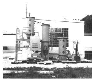
Bild 3. «Geregelte» Pilotanlage zur biologischen Abwasserreinigung nach dem Prinzip der Schlammwiederbelüftung.
