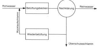
Bild 4. Belebtschlammverfahren mit Rücklaufschlammbelüftung.
