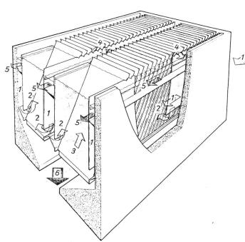
Bild 1. Schematische Darstellung eines Lamellenklärers. 1 Rohwasserkanal, 2 Eintritt Rohwasser in Lamellenzelle, 3 Aufwärtsströmung des Wassers zwischen den Lamellen, 4 Überlaufrinne Reinwasser, 5 Reinwasserkanal, 6 Schlammsammler.
