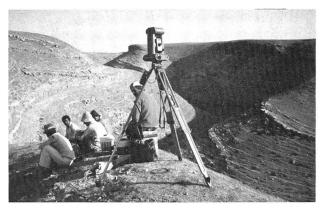
Bild 1. Der Tachymat TC 1 im Einsatz in Irak
