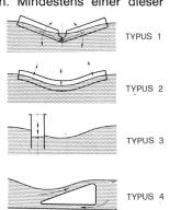
Bild 4. Typen von Wellennutzern. 1 Schwankende Flosse und Tauchwände. 2 Undulierende Balken und Schläuche. 3 Oszillierende Wassersäule. 4 Gleichrichter.
