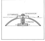
Bild 14. Das künstliche Atoll der Firma Lockheed. Vertikalschnitt.
