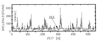
Bild 3. Typische Ganglinie der Wellenleistung nach [6]. Die mittlere Wellenleistung der betrachteten 540 s ist 39.4 kW/m.
