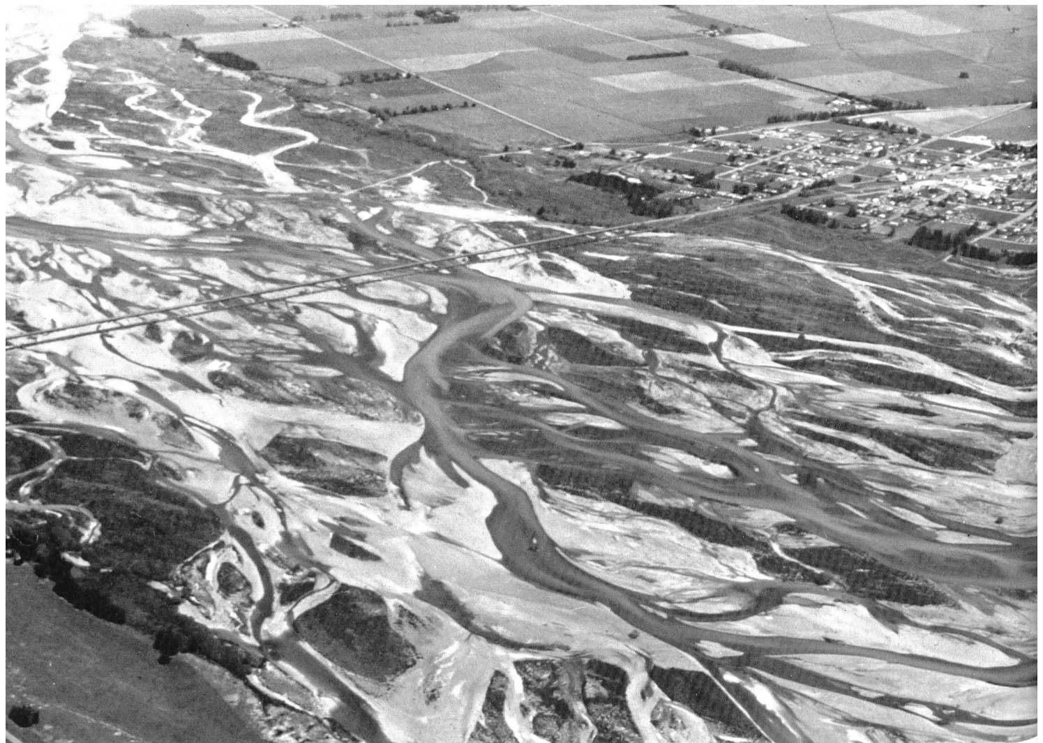
Bild 6. Rakaia River, Canterbury, Neuseeland, Unterlauf; hier ist das Bett etwa 2 km breit. Bevorzugte Fliessrichtungen des Niederwassers: schräg zur Richtung des Flusslaufs oder um Bänke herum schlängelnd.
