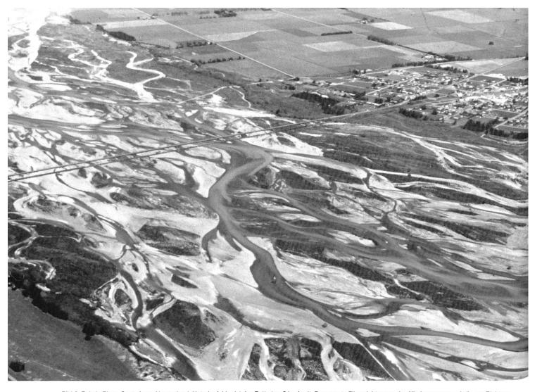
Bild 6. Rakaia River, Canterbury, Neuseeland, Unterlauf; hier ist das Bett etwa 2 km breit. Bevorzugte Fliessrichtungen des Niederwassers: schräg zur Richtung des Flusslaufs oder um Bänke herum schlängelnd.
