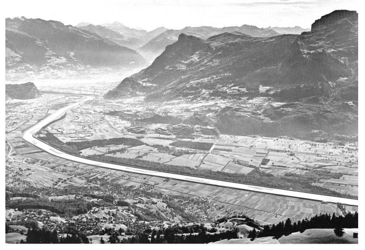
Bild 8. Rhein bei Sargans. Alternierende Bänke in einem korrigierten Fluss, «Läufe» («Riffles») zwischen, «Hinterwasser» («Pools») neben den Bänken.
