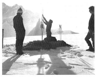
Bild 7. Schneedichtemessungen mit einer Neutronensonde auf dem Jungfraujoch.
