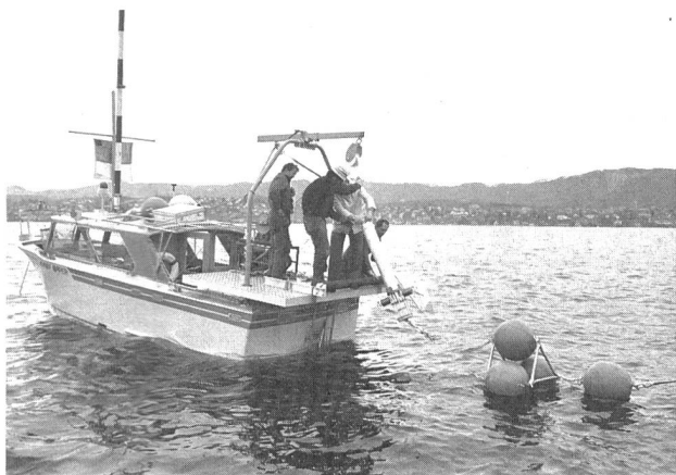
Bild 5. Messungen der Strömungen im Zürichsee. Einbringen von Messinstrumenten (Bild Beat Marti).
