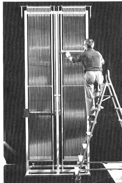
Bild 4. Eine «Messharfe» von Standrohren zur Messung von Drücken in hydraulischen Versuchsanlagen.
