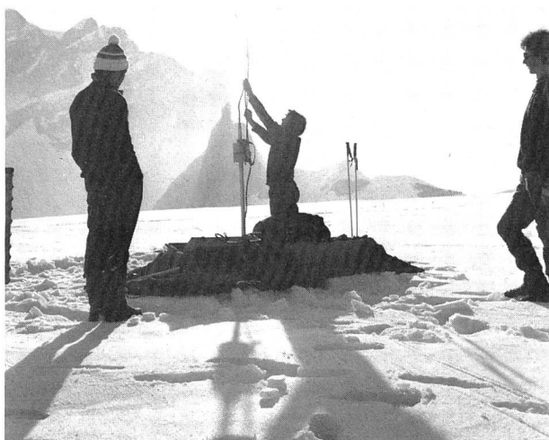
Bild 7. Schneedichtemessungen mit einer Neutronen-sonde auf dem Jungfraujoch.
