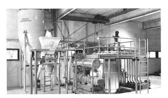
Bild 1. Die Bühler-Schlammtrocknungsanlage ZTD-2/6, wie sie in der Abwasserreinigungsanlage Altenrhein installiert ist.
