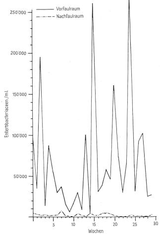
Bild 2. Beispiel einer guten Methanfaulung bei der Klärschlammbeseitigung. Verminderung der Enterobacteriaceen-Zahl vom Vor- zum Nachfaulraum, unpasteurisiert. Die Verminderung beträgt im Mittel um 90 %.
