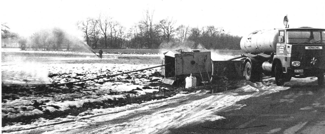
Mit einem Zisternenwagen wird der Faulschlamm in ein Bassin geführt und von dort mit einer mobilen Pumpe verspritzt.
