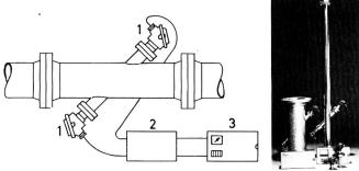
Bild 1, links. Prinzipskizze des Ultraschall-Durchflussmessgerätes. 1 die beiden Ultraschallwandler, 2 der Messumformer, 3 der Volumenzähler.
