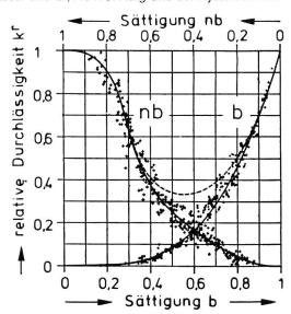
Bild 1. Experimentell bestimmter Verlauf einer  $k^r = k^r_{(s)}$  nach *Wyckoff* und *Botset* (1936)
