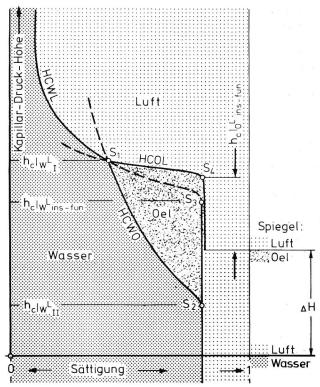
Bild 2. Sättigungsbild für Öleintritt an Orten, wo  $h_{c|W}^{\perp} = h_{c|W}^{\perp}$  oder  $h_{c|W}^{\perp}$ <sub>II</sub>.
