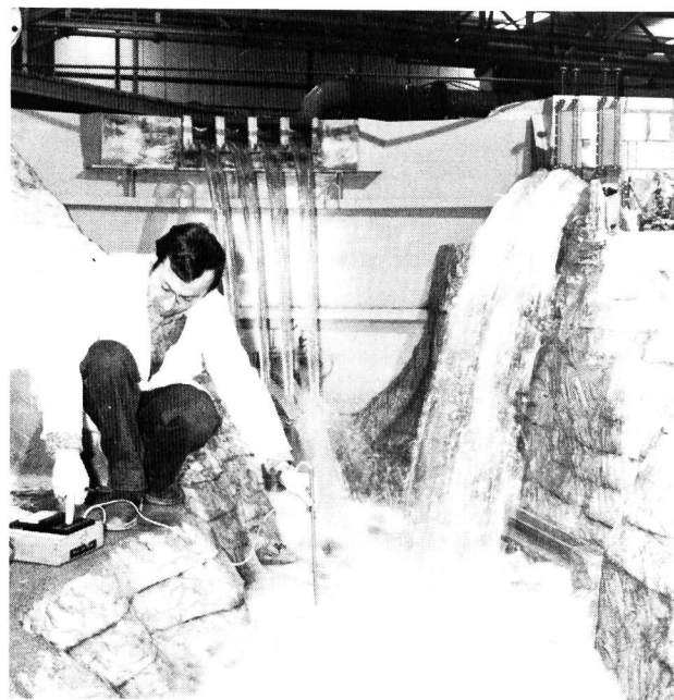
Bild 1. Die 226 Meter hohe, von Motor-Columbus Ingenieurunternehmung AG, Baden, projektierte Bogenmauer El Cajon in Honduras wurde an der Versuchsanstalt für Wasserbau der Eidgenössischen Technischen Hochschule Zürich 100mal verkleinert als Modell nachgebildet. Es wird hier untersucht, wie auch die grössten Hochwasser gefahrlos abgeführt werden können. Auf der linken Talseite, im Bild rechts, führen zwei Umleitstollen Wasser aus dem Stausee ins Unterwasser. Aus vier Überfallöffnungen in der Staumauerkronen ergiessen sich vier Sturzbäche über die Mauer, Bildmitte. Aus drei Grundablässen können weitere Wassermengen abgeleitet werden, Bildmitte. Insgesamt können so 8500 m 3 /s abgeführt werden, was der achtfachen mittleren Wasserführung des Rheins bei Basel oder der neunzigfachen der Limmat bei Zürich entspricht. Im Vordergrund zeigt ein Ingenieur eine Geschwindigkeitsmessung mit einem Messflügel, die direkt elektronisch ausgewertet wird.
