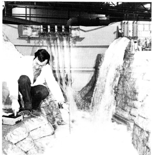
Bild 1. Die 226 Meter hohe, von Motor-Columbus Ingenieurunternehmung AG, Baden, projektierte Bogenmauer El Cajon in Honduras wurde an der Versuchsanstalt für Wasserbau der Eidgenössischen Technischen Hochschule Zürich 100mal verkleinert als Modell nachgebildet. Es wird hier untersucht, wie auch die grössten Hochwasser gefahrlos abgeführt werden können. Auf der linken Talseite, im Bild rechts, führen zwei Umleitstollen Wasser aus dem Stausee ins Unterwasser. Aus vier Überfallöffnungen in der Staumauerkrone ergiessen sich vier Sturzbäche über die Mauer, Bildmitte. Aus drei Grundablässen können weitere Wassermengen abgeleitet werden, Bildmitte. Insgesamt können so 8500 m 3 /s abgeführt werden, was der achtfachen mittleren Wasserführung des Rheins bei Basel oder der neunzigfachen der Limmat bei Zürich entspricht. Im Vordergrund zeigt ein Ingenieur eine Geschwindigkeitsmessung mit einem Messflügel, die direkt elektronisch ausgewertet wird.
