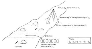
Bild 1. Schema der Abflussmessung nach dem Salz-Verdünnungs-Verfahren.
