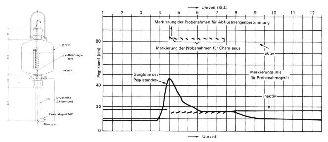
Bild 4, links. Mariottsche Flasche für die automatische Beschickung (alle Masse in mm).
