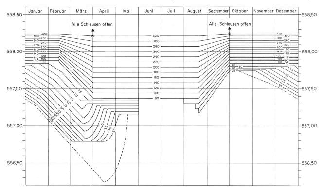
Bild 7. Das bisher verwendete Regulierreglement für den Thunersee ist ein reines Linienreglement: jedem Wasserstand im Thunersee entspricht ein Abfluss-Sollwert der Aare in Thun in Funktion der Jahreszeit. Kurvenbezeichnungen: Abfluss-Sollwerte in m³/s. Höhen der Thunersee-Wasserstände R.P.N. 373,60 m.
