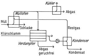
Bild 6. Schlammwasserverdampfung mit Rauchgas.
