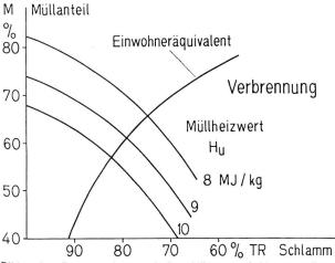
$\mathsf{Bild}$  3. Der Zusammenhang zwischen Müllanteil, Schlammanteil und Müllheizwert.
