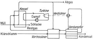
Bild 8. Schlammwasserverdampfung mittels Rauchgas und Brüdenverdichtung.
