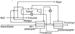
Bild 9. Schlammwasserverdampfung mittels Dampf und Brüdenverdichtung.
