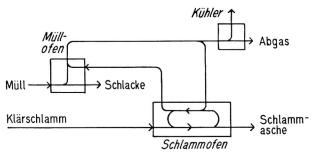
Bild 4. Der Energiefluss bei Rauchgasrückführung.
