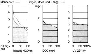
Bild 21. Die Häufigkeitsverteilung der Werte Trübung, DOC und UV 254 nm im Rohwasser der Werke Männedorf, Horgen, Moos-Zürich und Lengg-Zürich.
