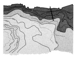
Bild 22. Topographie des Seegrundes an der Fassungsstelle Männedorf. Massstab 1:35 000.
