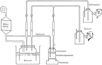
Bild 2. Schema der Geruchstestapparatur. Das Mischverhältnis (Gas/ Luft) im Testluftstrom wird durch Veränderung des Gasstromes reguliert. Als Vergleichsbasis für die Testpersonen dient der Referenzluftstrom.
