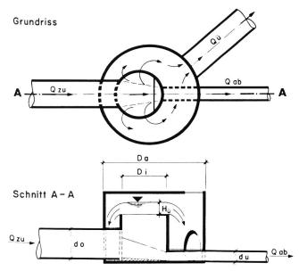
Bild 1. Anordnung der Hochwasserentlastung mit runder, hochliegender Überfallkante.
