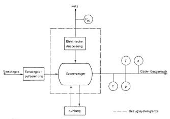
Bild 1. Prinzipieller Aufbau einer Ozonerzeugungsanlage mit Messsystemen.
