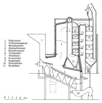
Bild 5. Längsschnitt durch den Dampferzeuger.
