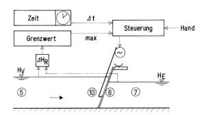
Bild 4. Automatisierung des Feststoffhaushaltes.
