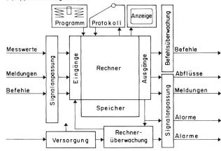
Bild 8. Prozessrechner für ein Laufkraftwerk
