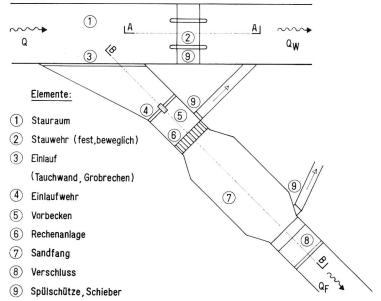
Bild 1. Die Elemente einer Wasserfassung.
