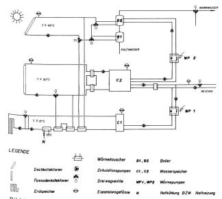
Bild 2. Prinzipschema der Sonnenheizanlage
