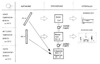
Bild 1. Energieflussdiagramm.
