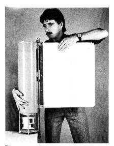
Bild 1. Strömungsmessgerät der Firma Inter Ocean (Kalifornien). Beschreibung im Text.
