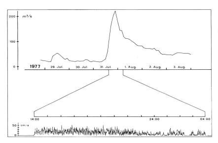
Bild 3. Oben: Abflusskurve der Glarner Linth vom 29. Juli bis 3. August 1977 gemäss Daten der hydrometrischen Station Mollis.
