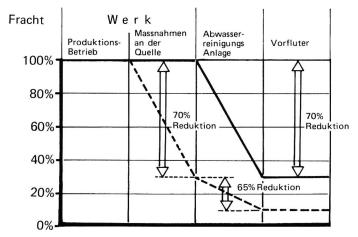
Bild 17. Massnahmen an der Quelle ergeben höhere Gesamtabbau-Raten.
