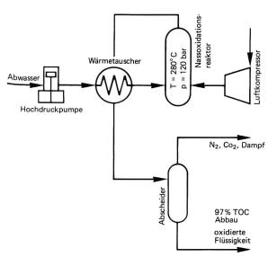
Bild 9. Nassoxidation von Chemie-Abwässern. Prinzipschema der eigentlichen Oxidation.
