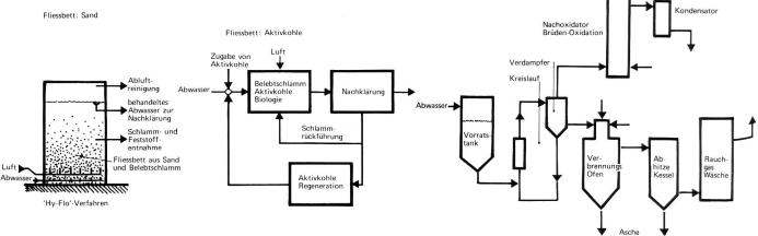
Bild 7. Biologische Abwasserreinigung, Fliessbett-Verfahren.
