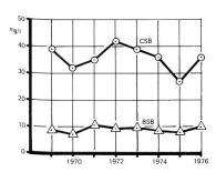
Bild 2. BSB<sub>5</sub> und CSB-Werte (mg/l) im Rhein beim Messpunkt Bimmen.
