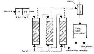
Bild 12. Aktivkohle-Adsorption für Nitrobenzol. A1, A2, A3: Aktivkohle-Kolonnen.
