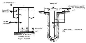
Bild 6. Biologische Abwasserreinigung, hohe Bauweise.
