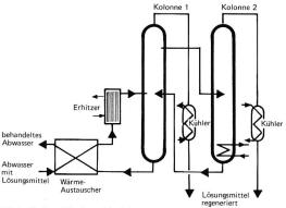
Bild. 10. Destillations-Verfahren.
