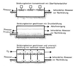
Bild 5. Biologische Abwasserreinigung, flache Bauweise.
