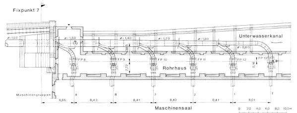
Bild 4. Lageplan der neuen Verteilleitung mit den Abgängen zu den Gruppen A und B der SBB, 1, 2 und 3 der BK und T der RhB.
